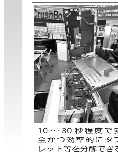
10〜30秒程度で安全かつ効率的にタブレット等を分解できる
