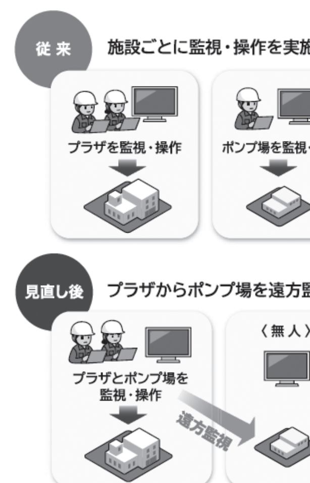
図2 ポンプ場の遠方監視化のイメージ
